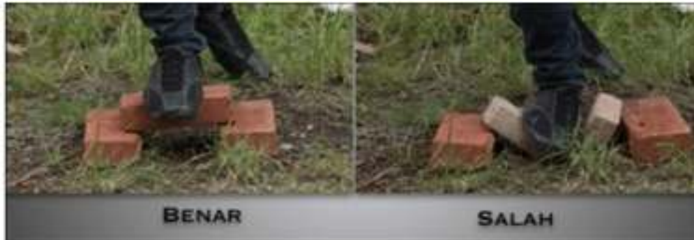
Gambar 13. Pengujian Sederhana Kekuatan Batu Bata
