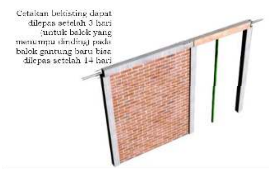
Gambar 61. Pelepasan Cetakan/ Bekisting
