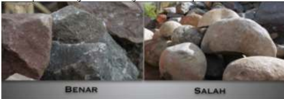
Gambar 10. Kualitas Batu Kali/Gunung yang Baik Digunakan Sebagai Pondasi
