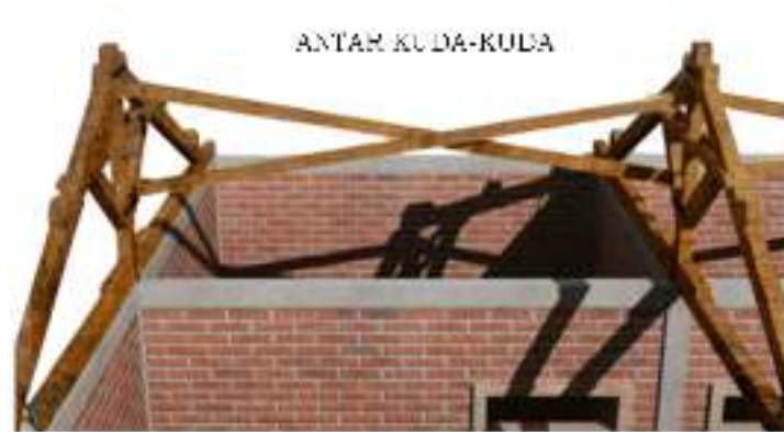
Gambar 34. Ikatan Angin Sebagai Pengikat Antar Kuda-Kuda Kayu
