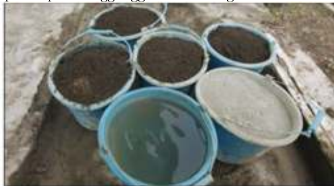
Gambar 7. Bahan Campuran Mortar
