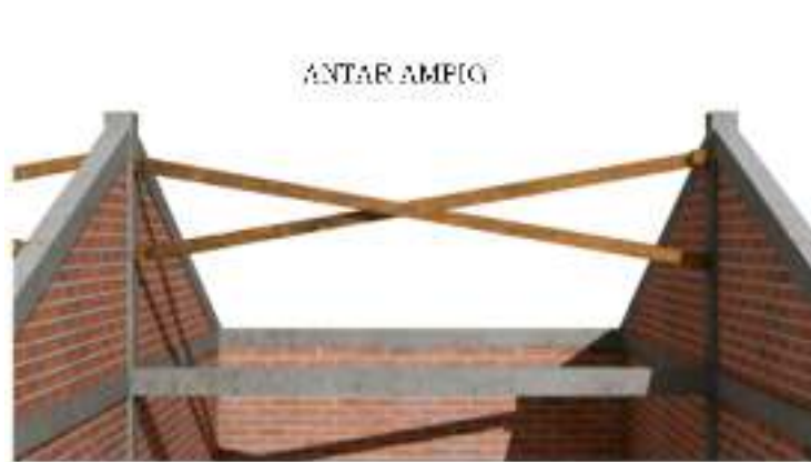
Gambar 35. Ikatan Angin Sebagai Pengikat Antar Gunung-Gunung/ Ampig
