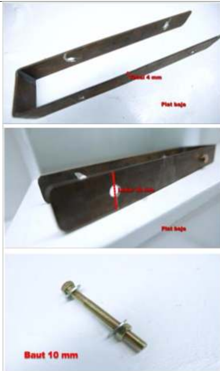
Gambar 30. Dimensi Plat Baja dan Baut Sebagai Pengikat Kuda-Kuda Kayu
